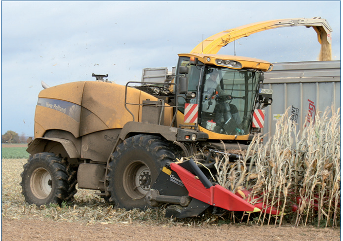
RDS/portal New Holland mit Digital-Steuerung 2-Leiter-Reifendruckregelsystem für Feldhäcksler
