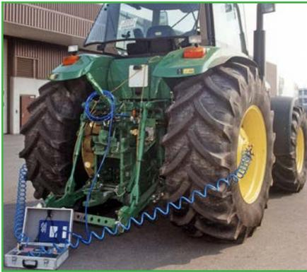
Der PTG-Aufschraubnippel, wird einmalig auf das Reifenventil aufgeschraubt, der Ventileinsatz wird zuvor entfernt (größerer Luftdurchlaß).
