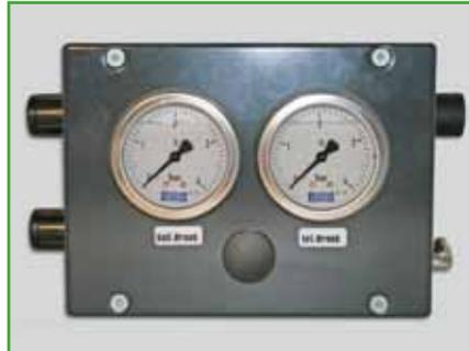
dann selbstständig wieder ab. Das System kann aber auch jederzeit manuell abgeschaltet werden. Da das System ständig Verbindung zu den Reifen hat, wird auf dem Ist-Druck-Manometer jederzeit der aktuelle Reifendruck angezeigt.
