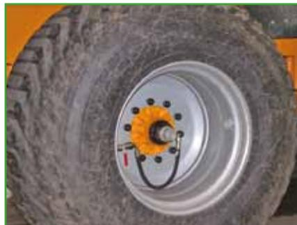
Langzeitfettfüllung (das lästige Abschmieren entfällt), hochwertige Dichtungen und Lager auszeichnet. Die Abdichtung zum Achstrichter erfolgt durch ein in Zusammenarbeit mit BPW entwickeltes Dichtungssystem, das im wesentlichen aus einem Klemmring und einer Lippen-Dichtung besteht. In der Felge
