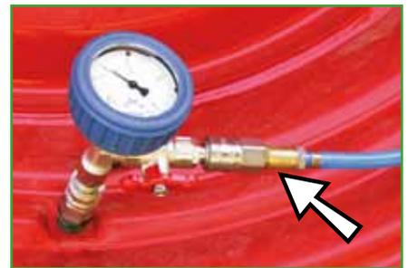
Das fest montierte Druckbegrenzungsventil im Füllschlauch (siehe Pfeil) schützt Manometer und Reifen vor Überdrücken und ermöglicht ein freihändiges Aufpumpen mit kontinuierlicher Druckanzeige.
