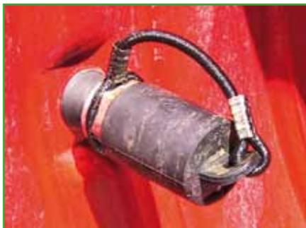
Der Kupplungskopf für den Anhängerbremsanschluß ist ein TÜV-freier Luftabgriff zum ortsunabhängigen, schnellen Aufpumpen.
