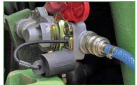
Der Füllschlauch wird in den Kupplungskopf eingesteckt, kann aber auch an jeden Werkstattkompressor angekuppelt werden.
