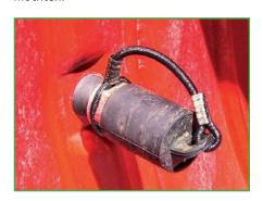
Die PTG-Aufschraubkupplung, wird einmalig auf das Reifenventil aufgeschraubt, der Ventileinsatz wird zuvor entfernt (größerer Luftdurchlaß).
